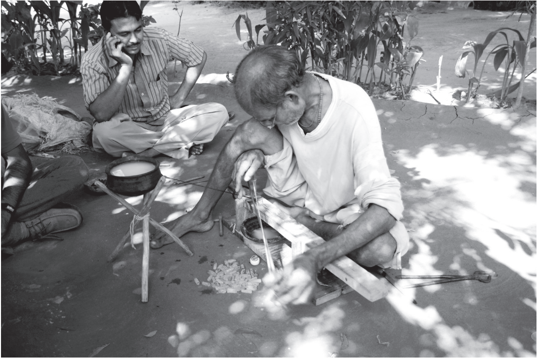
写真2 弓錐技法で石製ビーズを穿孔する職人（2012年10月23日筆者撮影）
