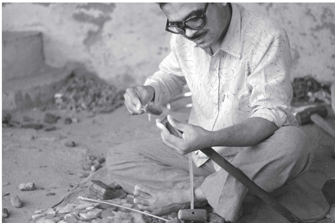
写真1 間接打撃技術で石製ビーズを成形する職人（2010年2月27日筆者撮影）
