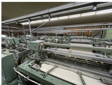
写真1 和紙の布の製織工程 (2022年6月21日学生撮影)
