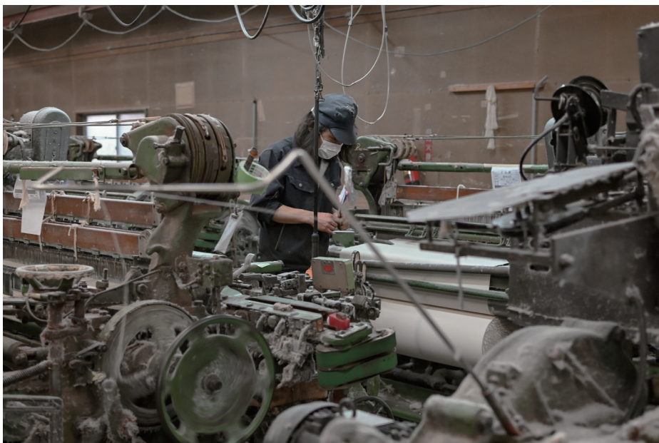
写真4 倉敷市児島にある帆布工場「株式会社タケヤリ」のシャトル織機（2022年3月9日池上撮影）
