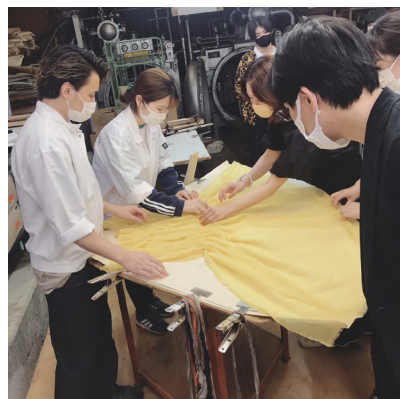
写真7 ハンドプリーツ加工を行っている様子
