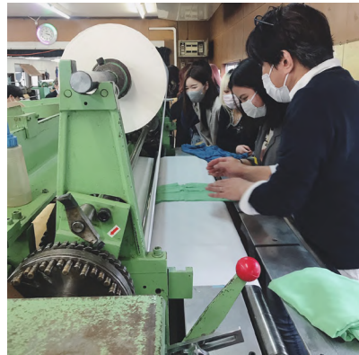
写真6 マシンプリーツ加工を行っている様子
