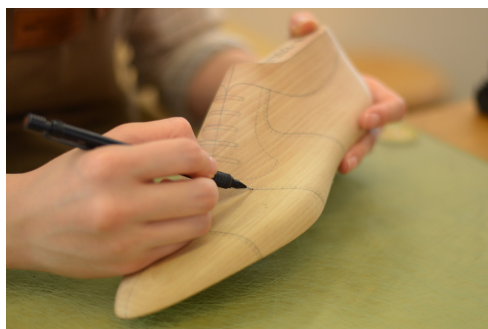
写真3 靴の制作にまず必要な木型作り （2022年2月9日柳町撮影）
