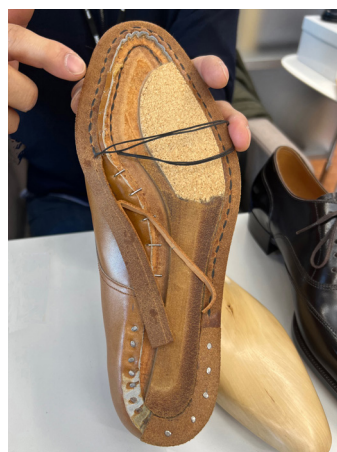
写真5 靴の構造部材のサンプル (2022年2月9日平井撮影)
